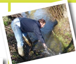
Étape 4 : placer la crépine au niveau d'un secteur du cours d'eau rapide, profond et sans vase. Actionner la pompe jusqu'à ce que l'eau jaillisse dans le bol en veillant à ce qu'il n'y ait pas d'entrée d'air
