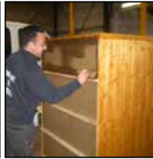
Et Xavier qui applique 3 couches de protection du bois !
